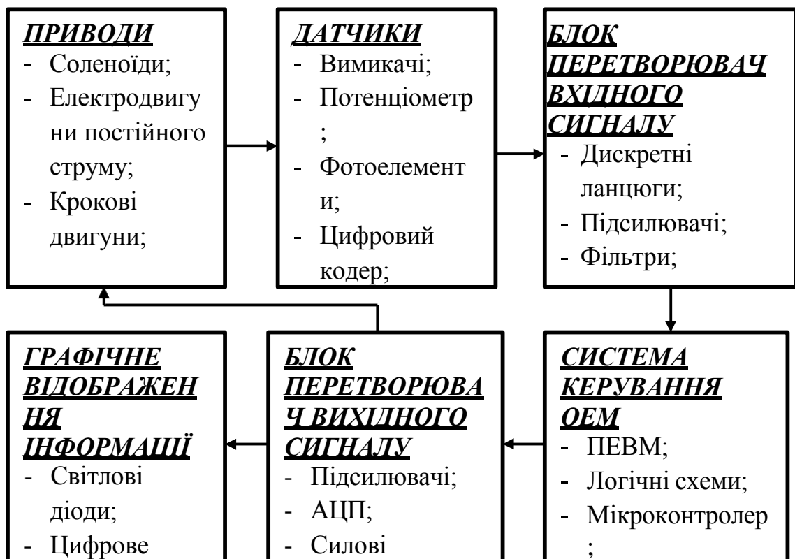
Рис. 2.2. Ієрархічна структура мехатронної системи
